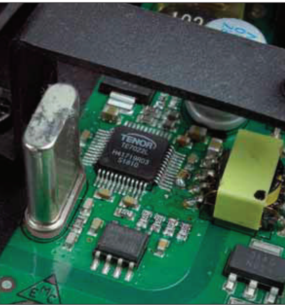
Der USB-Receiver ist maßgeblich an der 96-Fähigkeit des iDac schuld
